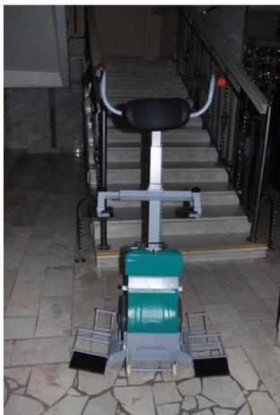
Рис 13 Механический подъемник инвалидного кресла
