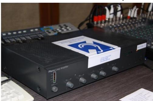
Рис. 3 Индукционная петля в актовом зале
